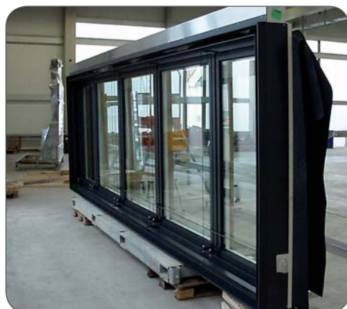
|| Die 6 Meter breiten und bis zu 1 Tonnen schweren geschosshohen Fassaden-Elemente werden in der Fertigungsstraße vorgefertigt. Ein Tieflader transportiert die komplett verglasten Elemente zur Baustelle.
