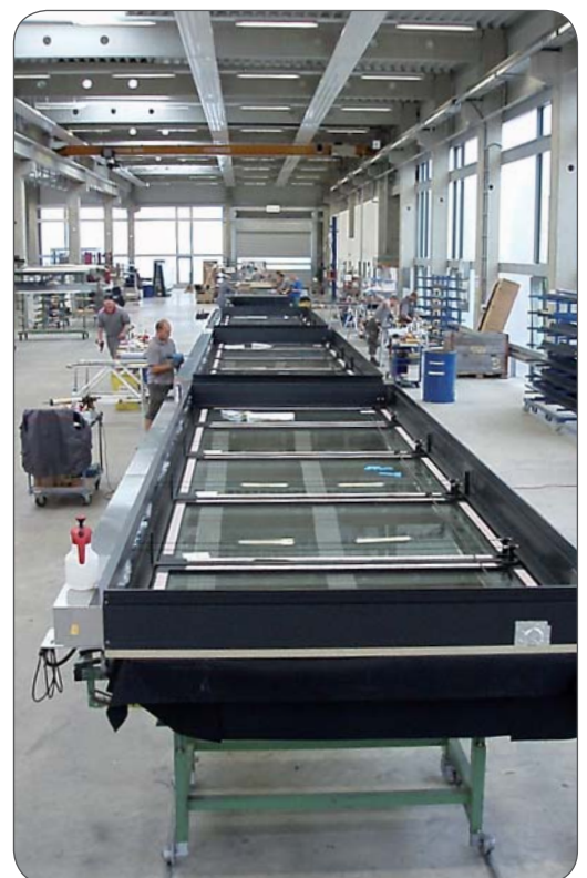
|| Die 6 Meter breiten und bis zu 1 Tonnen schweren geschosshohen Fassaden-Elemente werden in der Fertigungsstraße vorgefertigt. Ein Tieflader transportiert die komplett verglasten Elemente zur Baustelle.
