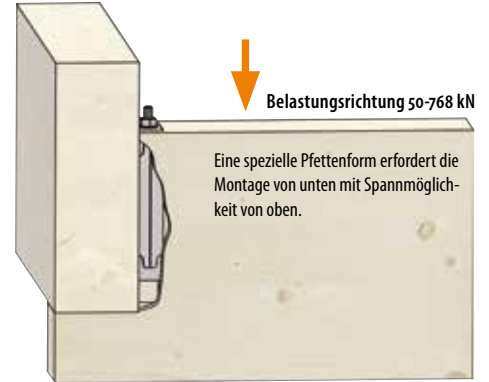
Einschubrichtung von unten
