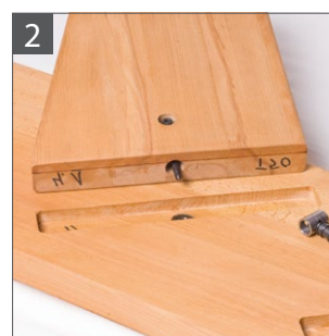
2 Spannelement in Bohrungen einlegen
