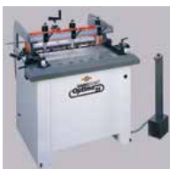
1) Bohren mit Dübelautomat
