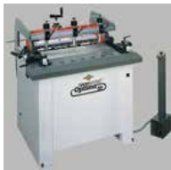
1) Bohren mit Dübelautomat
