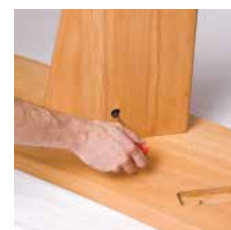
3) Elemente verspannen (SW 4)
