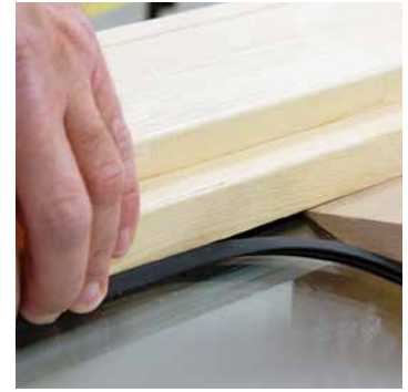
Anpressdruck über die Keildichtung
