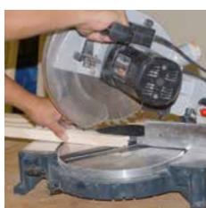
1) Glasleiste und FIXclip-Schiene zuschneiden
