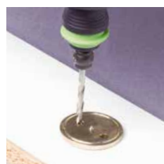
2) Mit Körner Bohrpositionen übertragen und \varnothing = 5 mm Löcher 12 mm tief vorbohren
