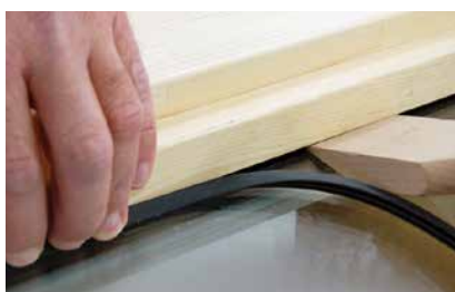
Anpressdruck über die Keildichtung
